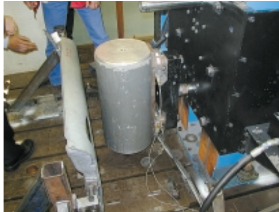
Bild 34 Testaufbau: quasi-statische seitliche Eindrückung
