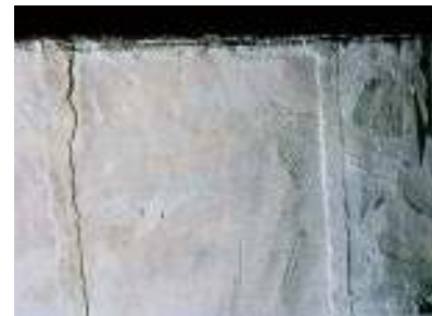
Abb. 24: Aufwachsen eines Zinküberzuges an blecheben geschliffenen Schweißnähten
