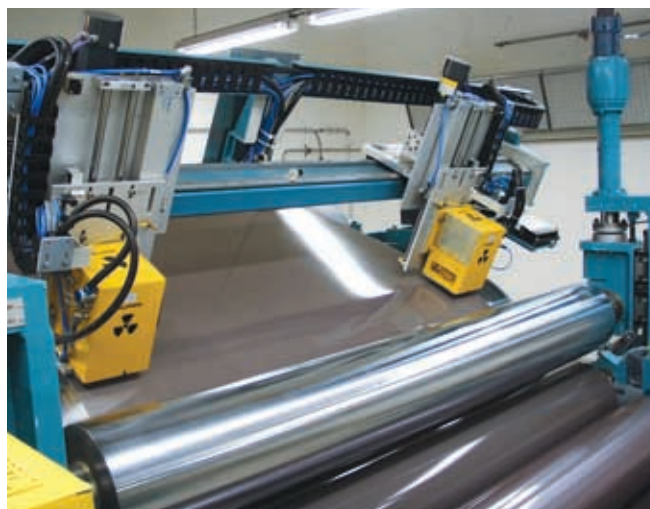
Abb. 4: Walzenauftragsverfahren von Korrosionsschutzprimern
