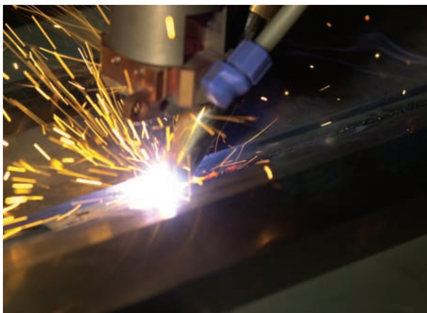
Abb. 8: Stahlfeinblech mit schweißgeeignetem Korrosionsschutzprimer - Laserstrahlschweißen
