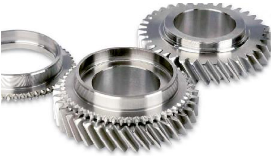
Schaltrad mit aufgefugter Synchronisierung bestehend aus warmumgeformtem Gangrad und warmumgeformter und bearbeiteter Synchronverzahnung
